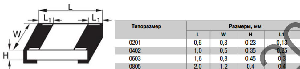
Рисунок 2.10 —типорозмір SMD 0805 та SMD 0603 та розмір вивідного резистора
