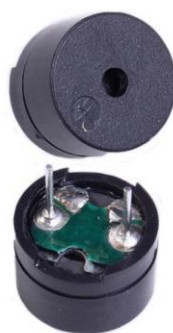
Рисунок 2.16 — звуковипромінювач 5 В, 2300 Гц
