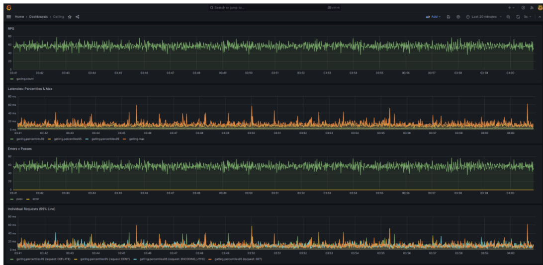
Рис.4.7. Метрики з гатлінгу за 20 хвилин роботи тестів навантаження
