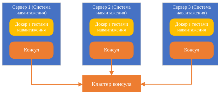
Рис.3.45 Схема роботи тестів навантаження
