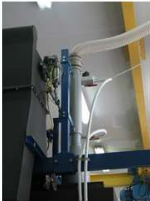
Рис. 2.10. Пристрій видалення пари та конденсації
