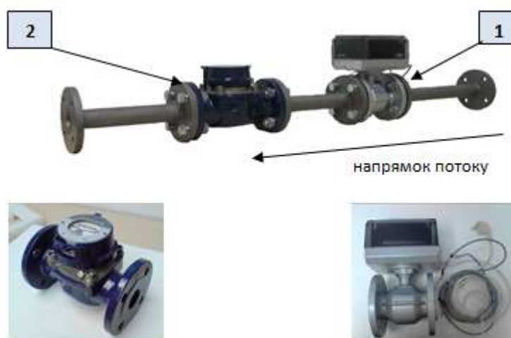
Рис. 4.10. Електромагнітний витратомір KROHNE (1) та витратомір Meistream Plus (2)
