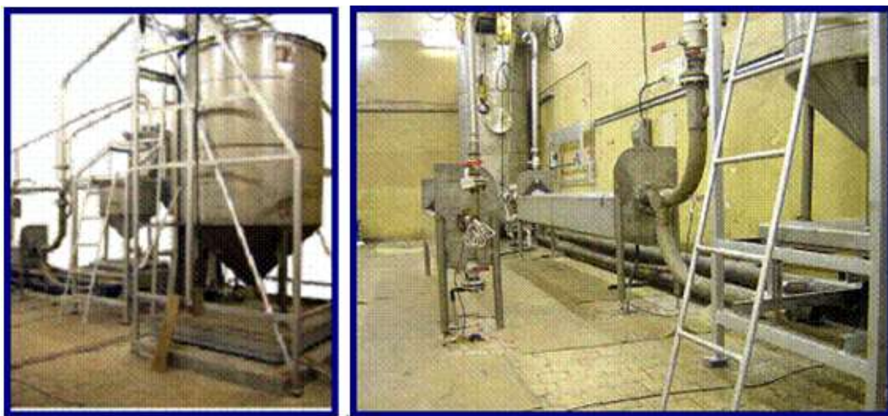
Рис. 1.12. Загальний вид Вихідного еталону одиниці масової та об'ємної витрати води Білорусі
