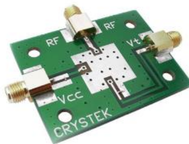
Рис.2.5 – фабрична схема підключення ГКН CEVAL-033 [26]
