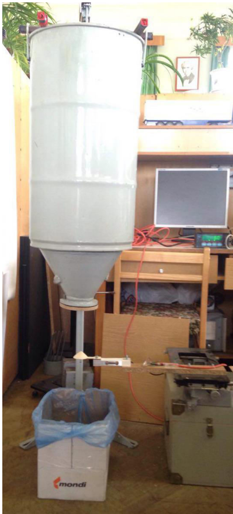
Рисунок 5.2 – Стенд для дослідження взаємодії потоку сипкого матеріалу з тілом обтікання
