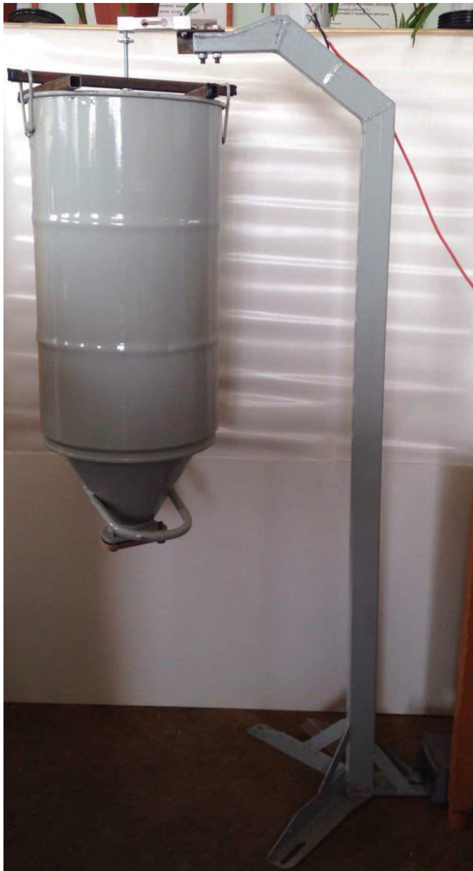
Рисунок 4.7 – Фотографія стенду для дослідження процесу витоку СМ
