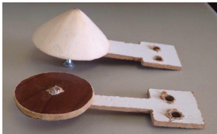
Рисунок 5.7 – Приклад закріплення тіл обтікання на балці
