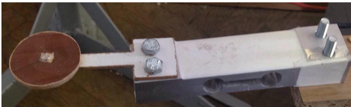
Рисунок 5.8 – Закріплення тіла обтікання на тензодатчику
