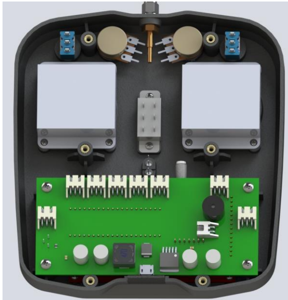
Рисунок 4.1 – Принцип встановлення та кріплення елементів передавача
