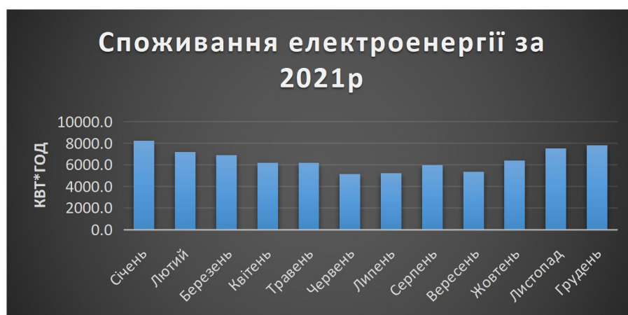
Рисунок 1.2 – Помісячний графік споживання електроенергії за 2021р
