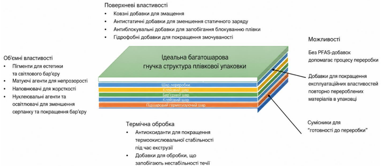
Рисунок 1.3. Структурна схема багатошарової гнучкої полімерної плівки із зазначенням функціональних добавок для модифікації її властивостей [8]
