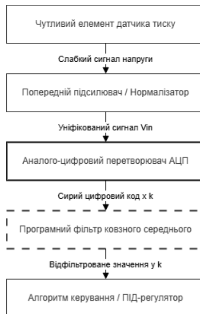
Рисунок 1.7. Функціональна схема вимірювального каналу (адаптовано з [14])
