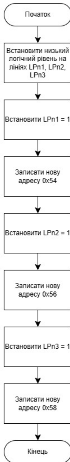
Рисунок 4.1 – Блок-схема алгоритму динамічної переадресації
