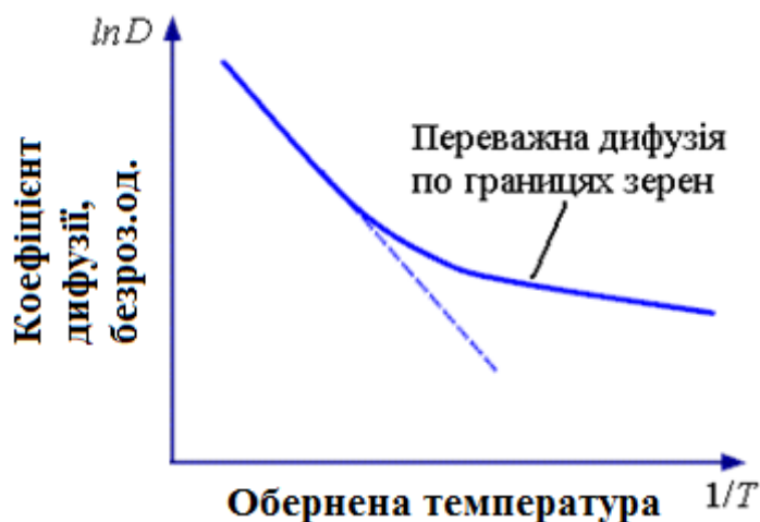
Рисунок 1.16 – Залежність коефіцієнта дифузії від температури в об'ємі та по границях зерен
