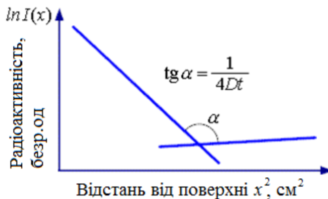
Рисунок 1.29 – Визначення коефіцієнту дифузії із залежності \ln I(x) = f(x^2)
