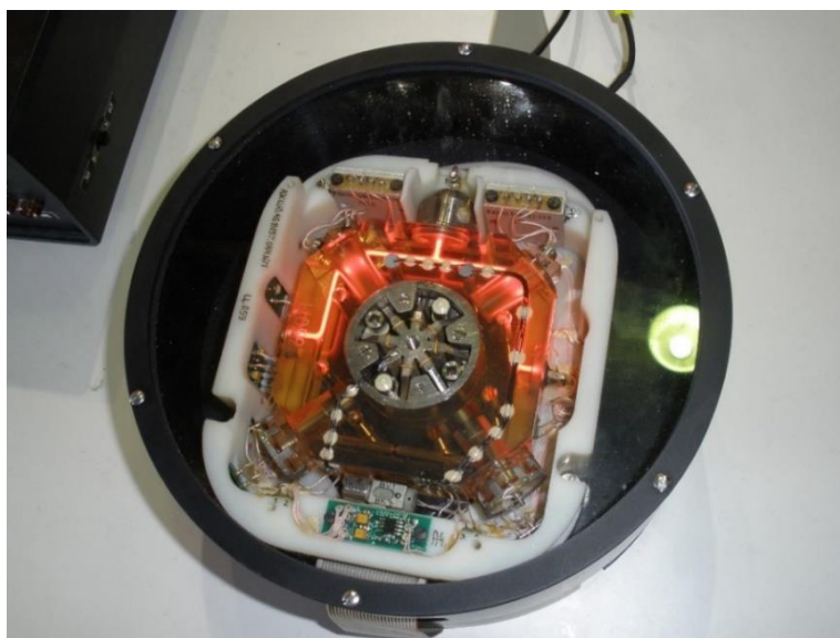
Рис. 1.5. КЛГ виробництва українського заводу “Арсенал” з резонатором квадратної форми та розташованим у центрі вібропідвісом [15].
