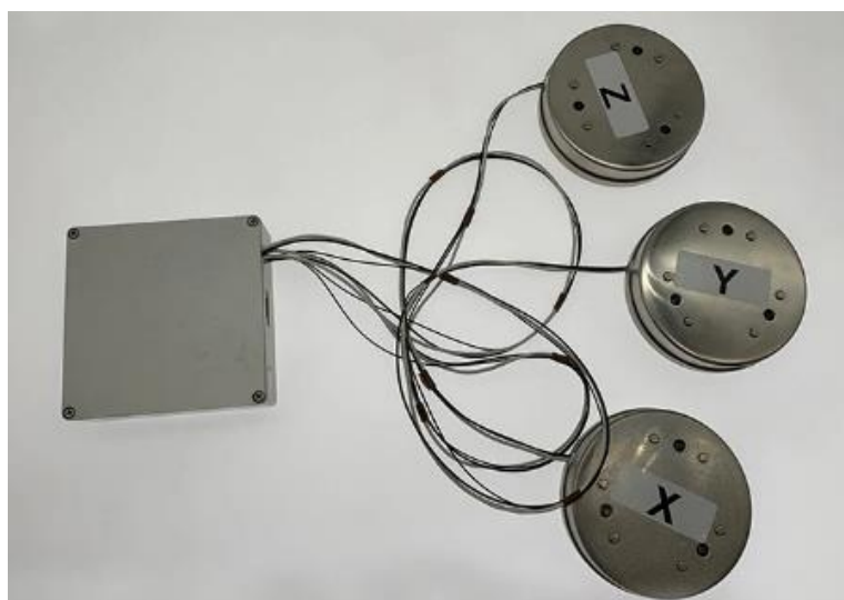
Рис. 1.7. Трьохосьовий волоконно-оптичний гіроскоп TFOG – 01.
