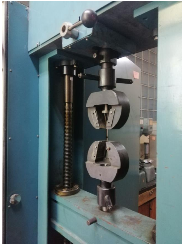
Рисунок 2.10 – Розривна машина моделі Р5
