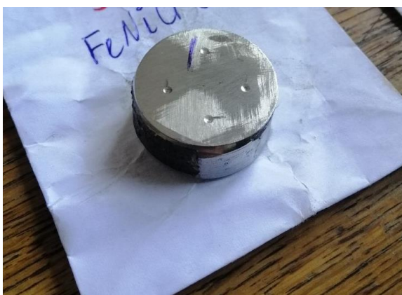
Рисунок 2.3 – Зразок у вигляді шайби для випробування на твердість
