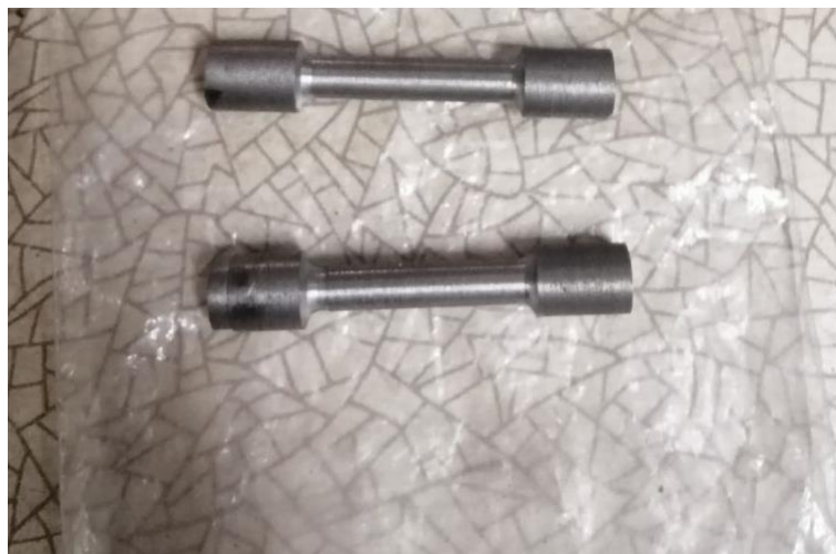
Рисунок 2.11 – Зразки діаметром 6 мм та довжиною 60 мм для випробування на розтяг
