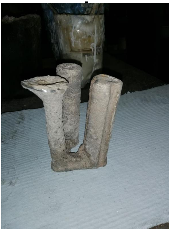
Рисунок 2.6 – Зразки з ливниковою системою, зліва направо: ливникова система, зразок 1 (на твердість), зразок 2 (на міцність)
