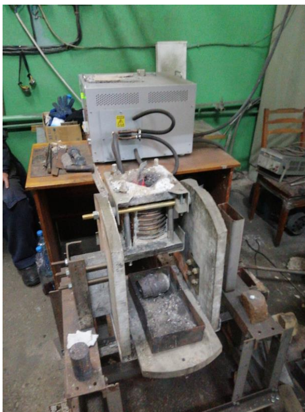
Рисунок 2.1 – Піч №1, індукційна з механізмом нахилу
