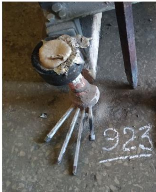
Рисунок 3.5 – Пруткова проба зі високоентропійного сплаву \text{Al}_{20}\text{Ni}_{20}\text{Cr}_{20}\text{Fe}_{20}\text{Cu}_{20}
