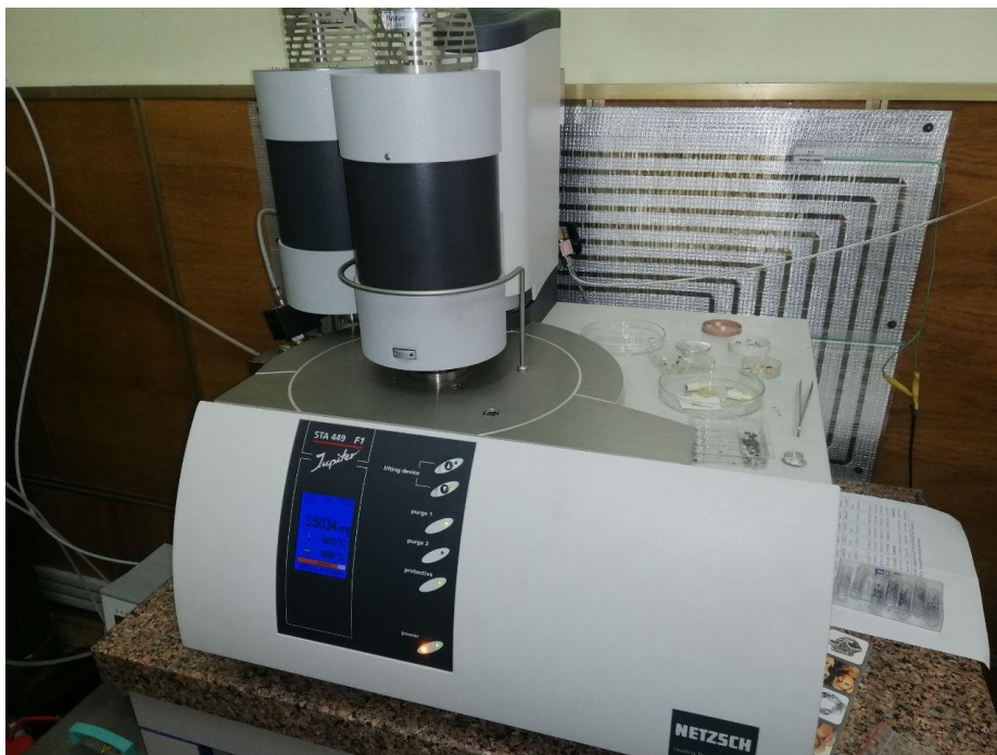
Рисунок 2.8 – СТА прилад “STA 449 F1 Jupiter”
