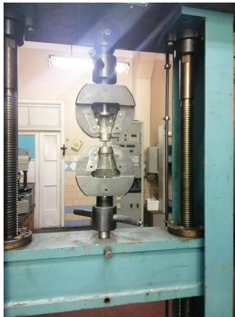
Рисунок 3.7 – Загальний вигляд кріплення зразка з високоентропійного сплаву \text{Al}_{20}\text{Ni}_{20}\text{Cr}_{20}\text{Fe}_{20}\text{Cu}_{20} для випробування на розтяг
