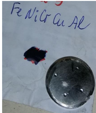
Рисунок 3.6 – Зразок шайба з високоентропійного сплаву \text{Al}_{20}\text{Ni}_{20}\text{Cr}_{20}\text{Fe}_{20}\text{Cu}_{20} для випробування методом Брінелля, наявні 4 точки вдавнення
