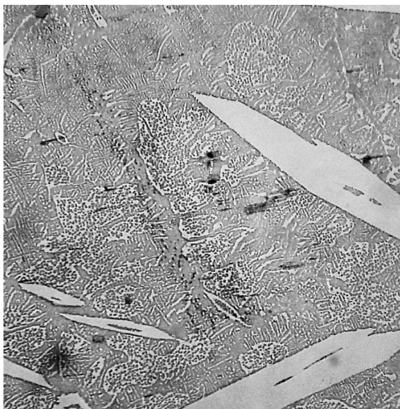
Рисунок 3.4 – Мікроструктура зразка (зі стояка) високоентропійного сплаву \text{Al}_{20}\text{Ni}_{20}\text{Cr}_{20}\text{Fe}_{20}\text{Cu}_{20} , збільшення \times 250
