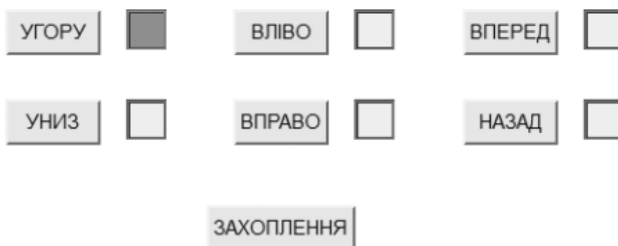
Рисунок 1.10 - Застосування MasterSCADA для найпростішого керування промисловим роботом МП-9С[5]
