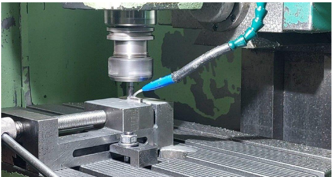
Рисунок 1.5 – Процес фрезерування заготовки
