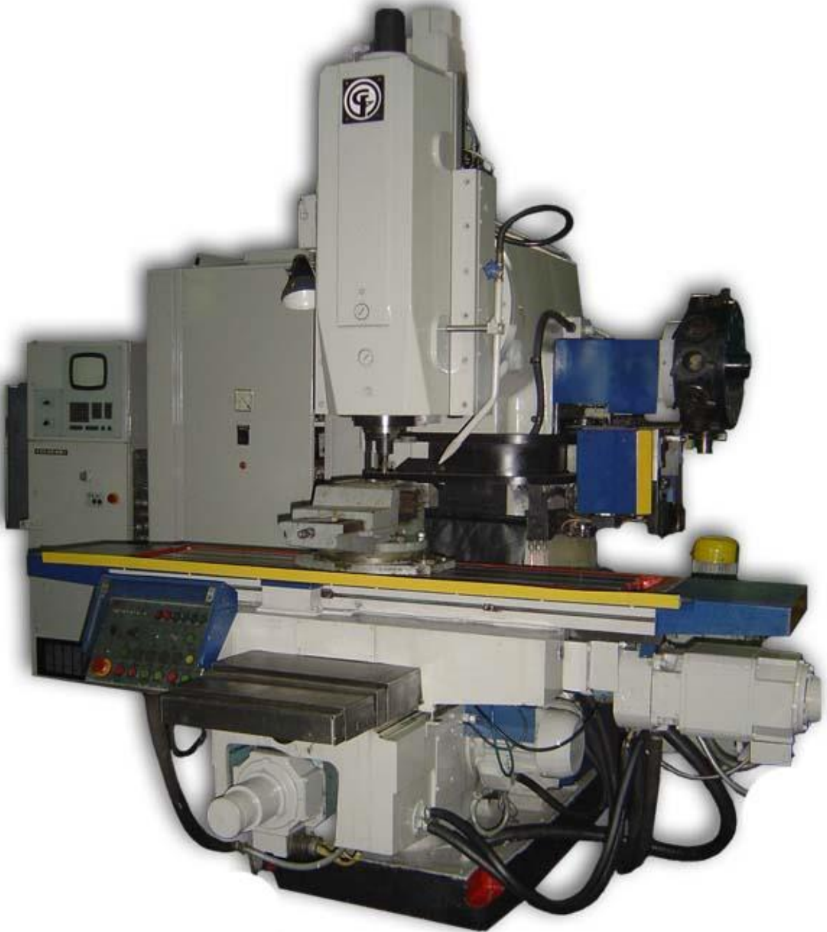
Рисунок 1.6 – Фрезерний верстат ГФ2171 [2]
