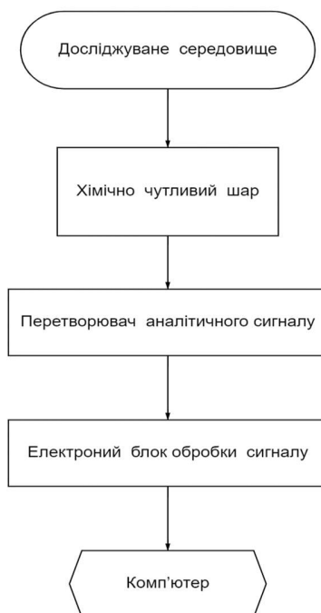
Рисунок 1.2 - Функціональна схема вимірювання за допомогою хімічного сенсора
