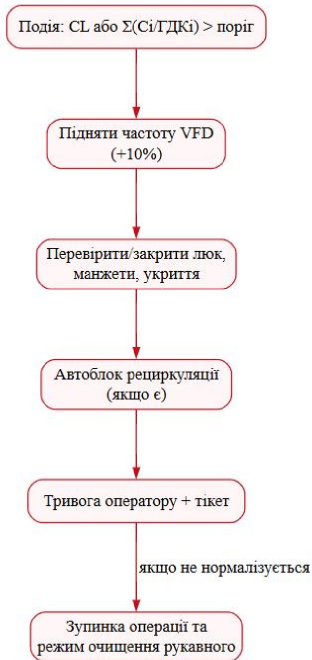
Рис. 2.1. – Алгоритм реагування на перевищення CL або \Sigma(C_i/\text{ГДК}_i) : послідовність дій VFD → перевірки укриттів → блок рециркуляції → тривога/тікети → безпечна зупинка.
