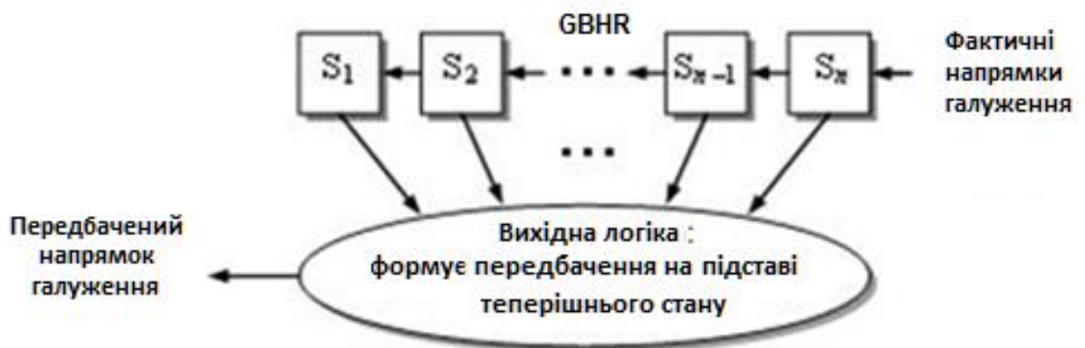
Рисунок 2.15 – Модель FSM для передбачення напрямку галуження на основі його попередньої історії
