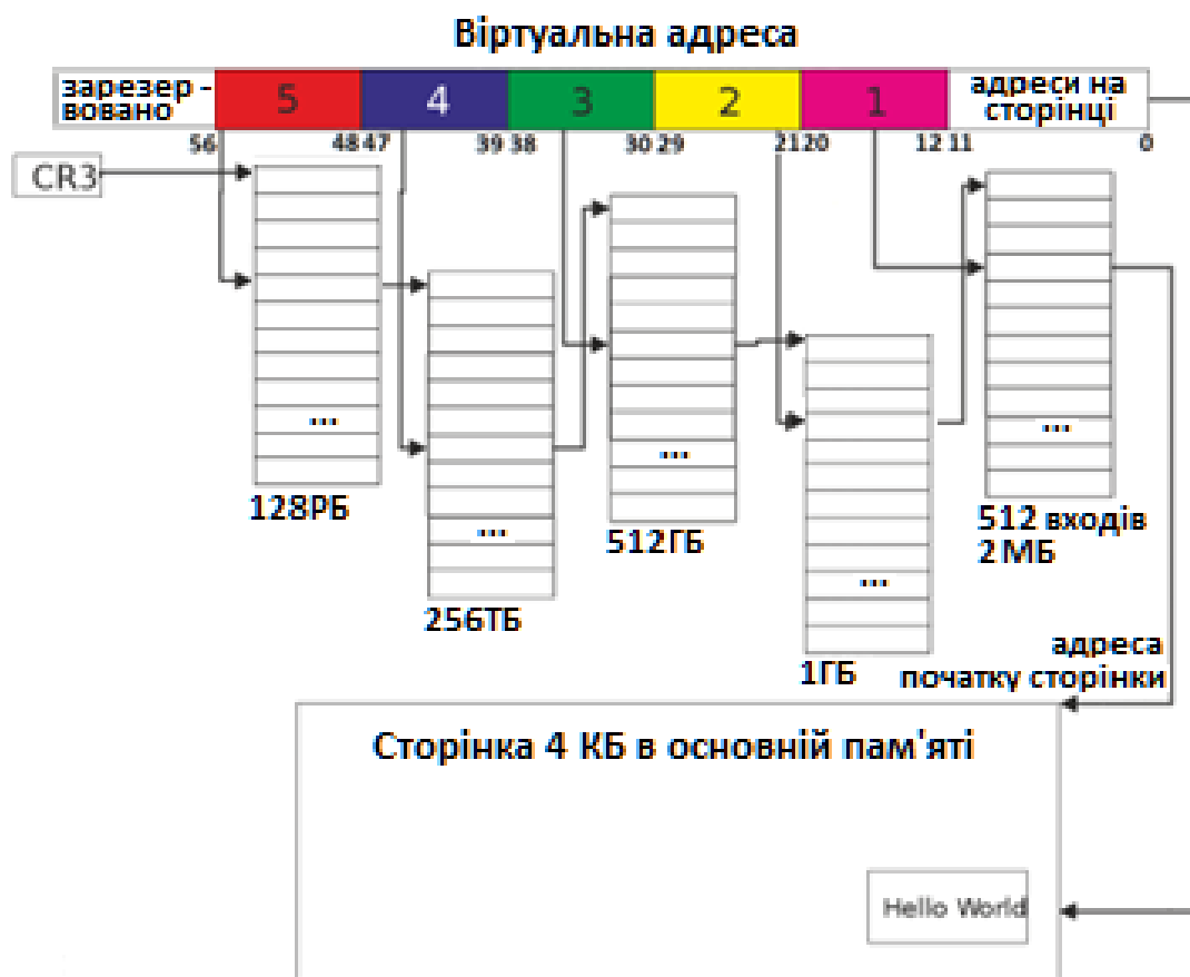
Рисунок 2.5 – Діаграма 5-рівневої структури таблиці сторінок (реєстр CR3 вказує на початкову адресу кореневої таблиці сторінок в RAM ).
