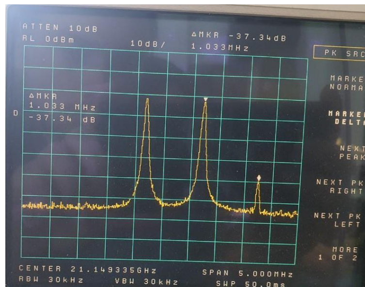
Рисунок 63 - Спектр підсиленого сигналу міксеру НМС264LM3 з різницею частот в 1 МГц із заданою атенюацією 5 дБ з проявами інтермодуляційних спотворень третього порядку
