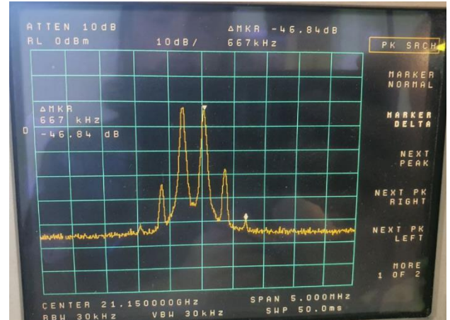
Рисунок 39 - Спектр сигналу міксеру HMC264LM3 з різницею частот в 300 кГц із заданою атенюацією 0 дБ з проявами інтермодуляційних спотворень третього та вищих порядків
