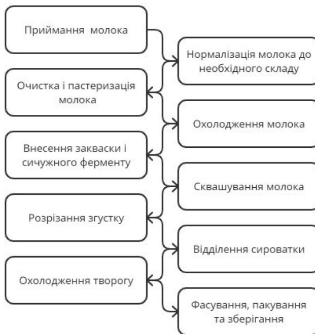
Рисунок 1.1.1 – Етапи виробництва творогу кислотним способом [4]
