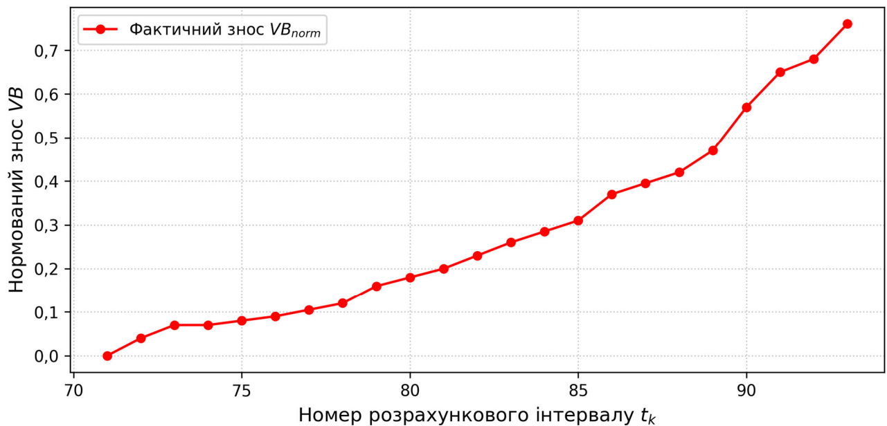
Рисунок 3.1 – Візуалізація динаміки зносу ріжучого інструменту (експеримент №11)
