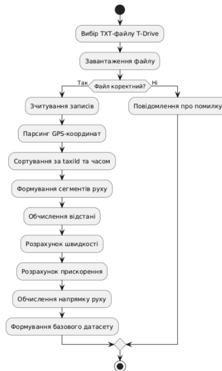
Рисунок 4.5 — Схема модуля завантаження та парсингу даних
