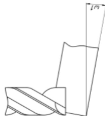
Утворення різальних кутів у різців з багатограничними пластинами: геометричні параметри різця
