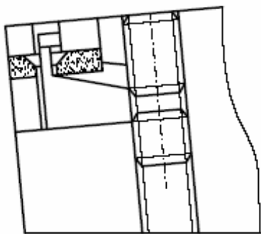
Рис. 1.7. Кріплення пластин L-подібним важелем
