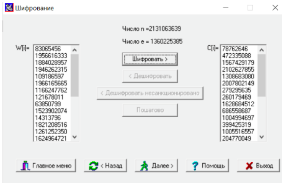
Рисунок 1.7 – Вікно демонстрації шифрування RSA
