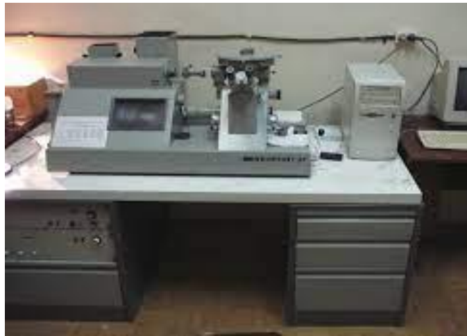
Рисунок 2.3 – Оптичний мікроскоп НЕОРНОТ-21
