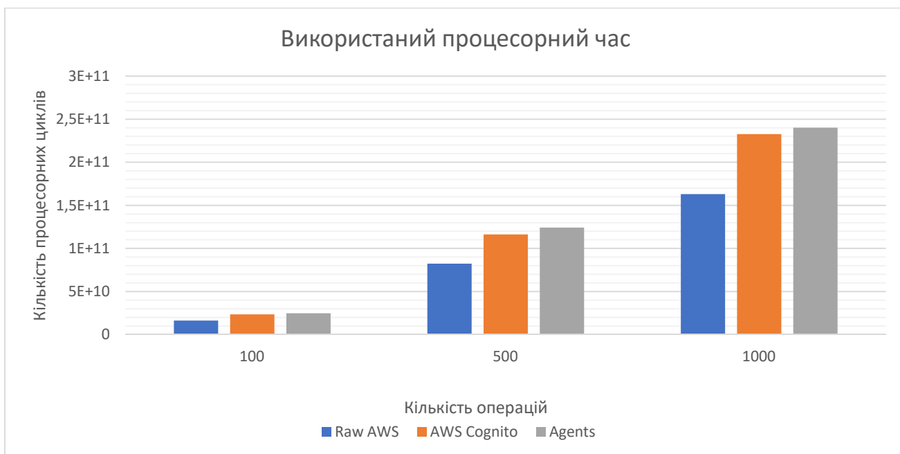
Рисунок 3.12 – Графік використання процесорного часу при аналізі
