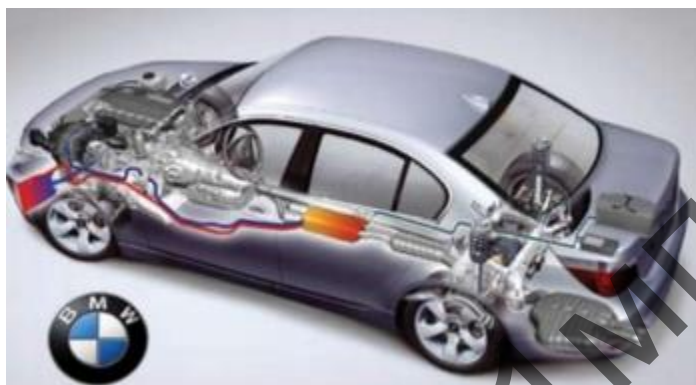
Рисунок 2.1 — Вироблення електроенергії термоелектричним генератором з використанням температури вихлопних газів автомобіля [10]
