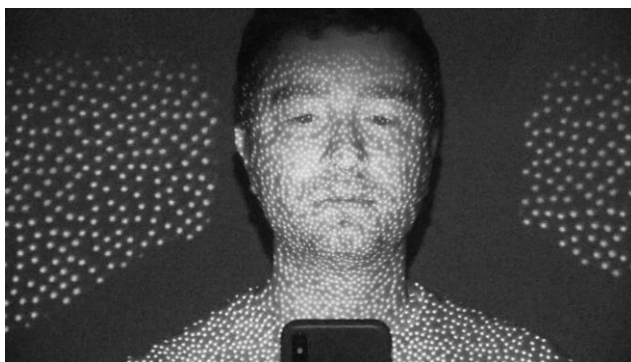
Рисунок 1.1 — Схема оптичного тракту камери TrueDepth та формування структурованого інфрачервоного патерна в системі FaceID
