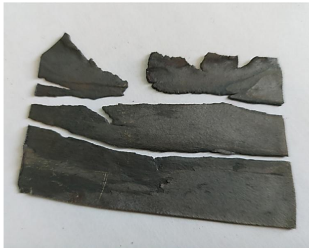
Рис. 3.3. Втрата суцільності матеріалу при гарячій прокатці.
