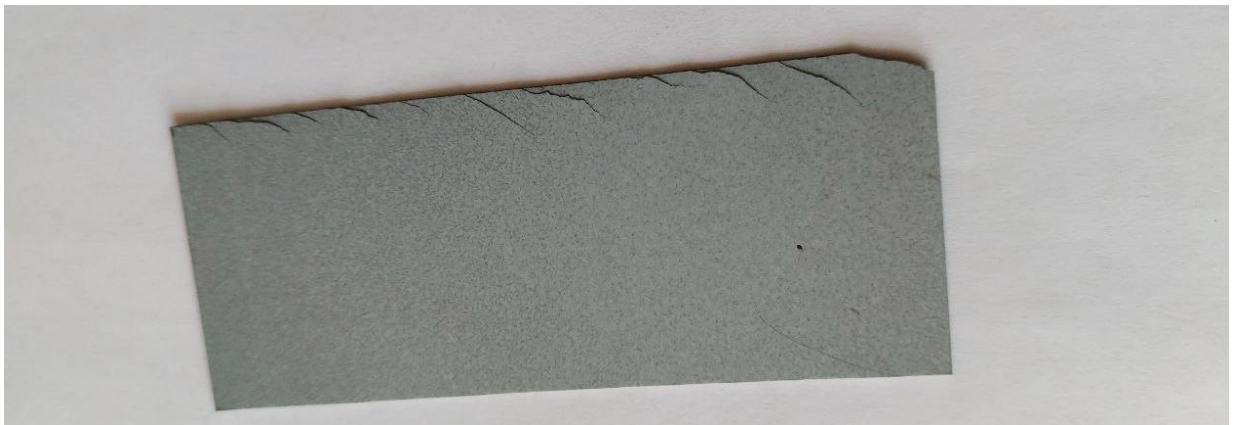
Рис.3.1. Тріщини крихкого матеріалу в місцях зрізу.
