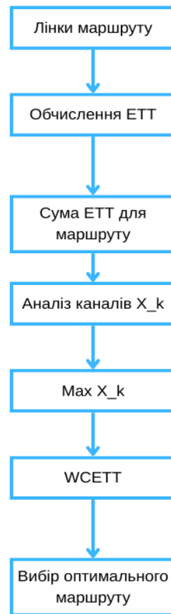
Рисунок 1.10 – Схема роботи метрики WCETT
