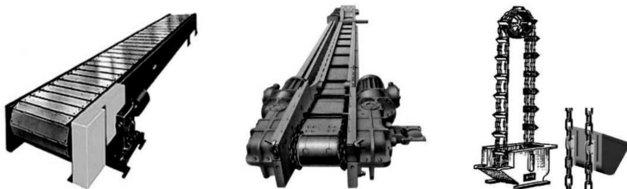
Рис.1.2. Пластинчатий, скребковий і ковшовий конвеєр [3]
