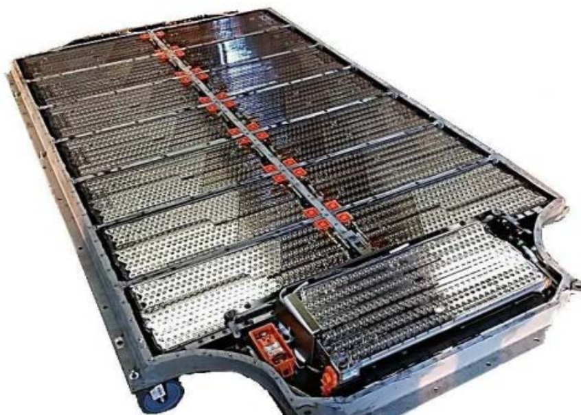
Рисунок 2.3 – Батарейний відсік Tesla S з батареями NCR 18650.
