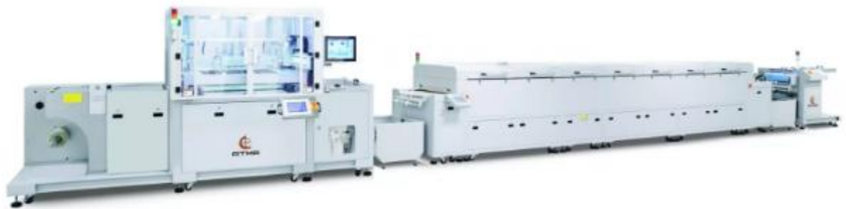
Рис. 1.10. Повністю автоматична лінія для трафаретного друку «з рулону в рулон» із реєстрацією біотестових смужок CCD ATMALINE_RR5060/C
