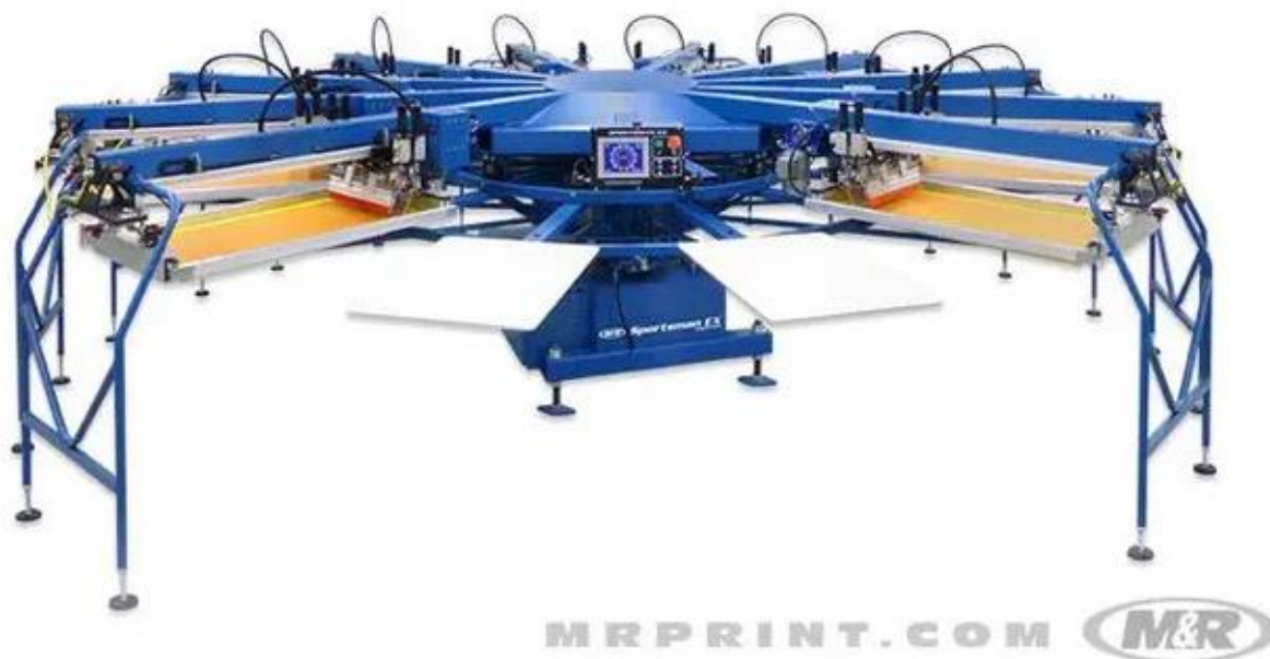
Рис. 1.5. Трафаретна автоматична карусельна друкарська машина за футболками та трикотажному кроєм M&R SPORTSMAN EX5070
