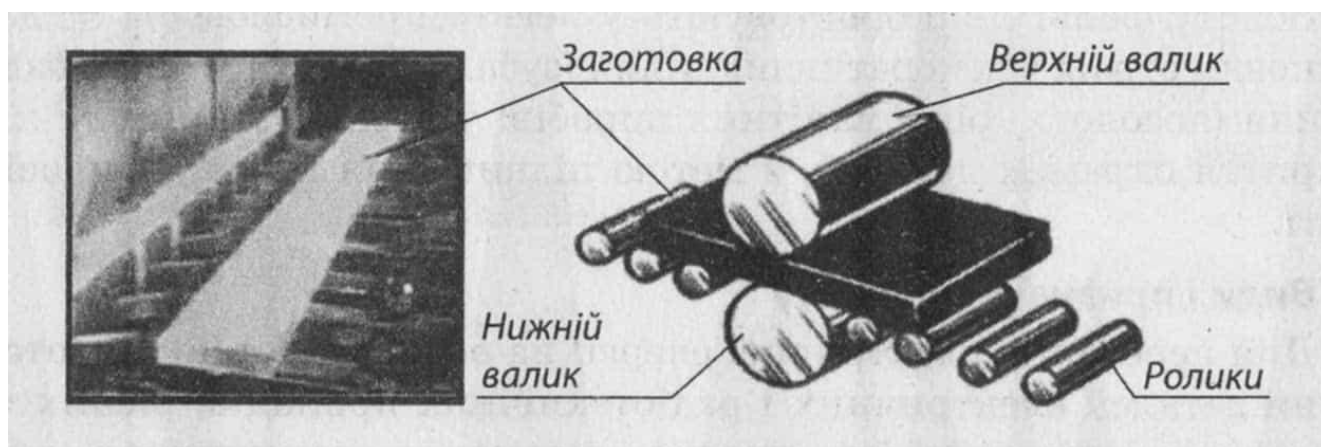
Рисунок 1.4 – Одержання листового металу на прокатному стані [31]
