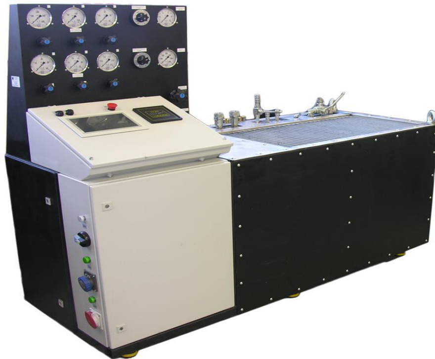
Рис 5.2 Стенд для зняття характеристик з гідравлічного обладнання.
