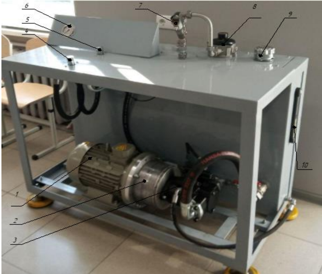
Рис.3.2 Загальний вигляд навчального стану для дослідження характеристик в регульованому аксіально-поршковому насосі.
