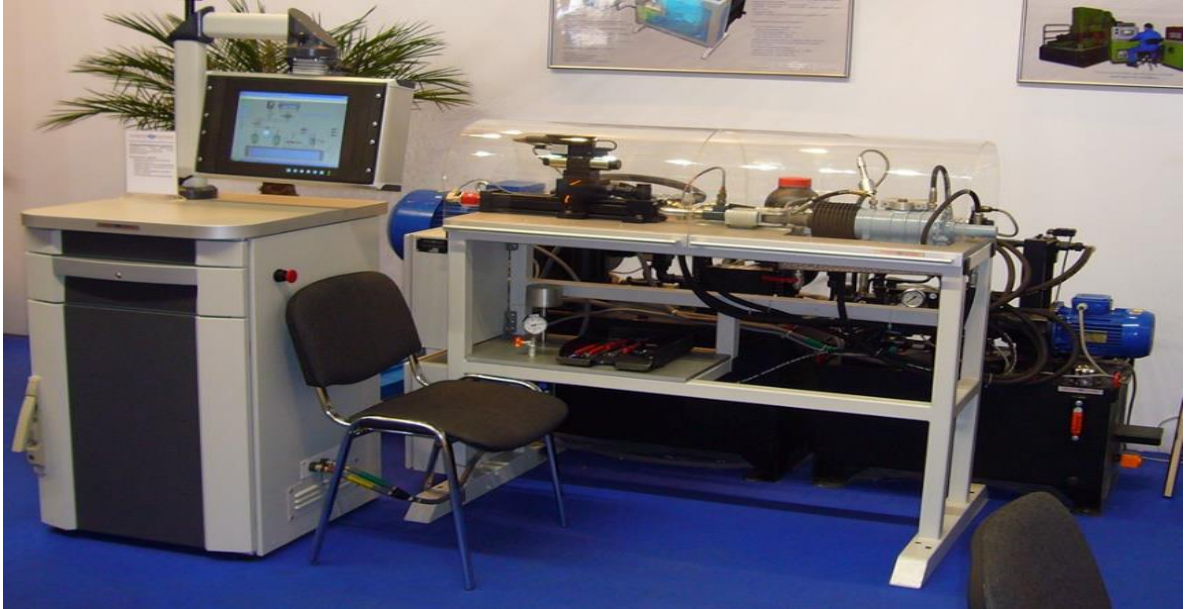
Рис. 1.7 Гідросистема стану для випробування демпфера вертолітних лопатей[2]
