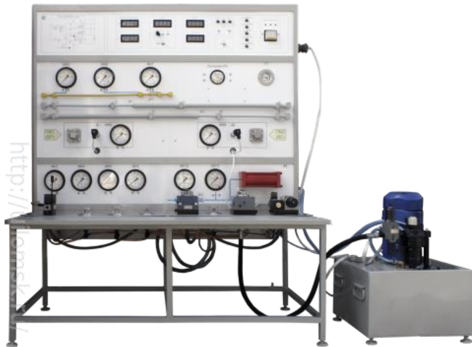
Рис.1.2 Стенд НТЦ-11.17.2 "Гідравліка М2".
