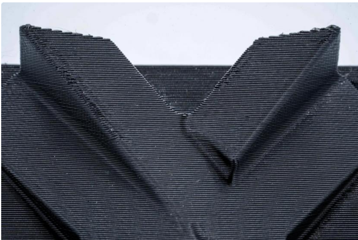
Рисунок 2.11. Збільшене зображення деталі, друкованої методом FDM без постобробки.
