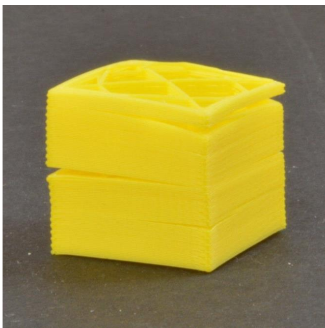
Рисунок 1.7. Роз'єднання шарів у друкованій деталі.
