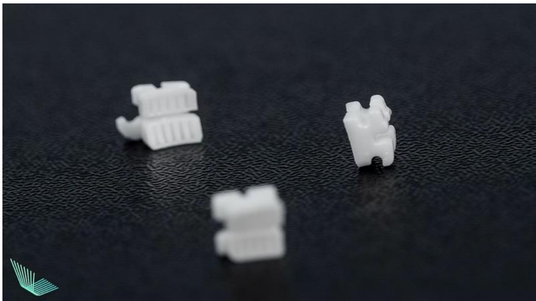
Рисунок 1.4. Друковані прототипи брекетів
