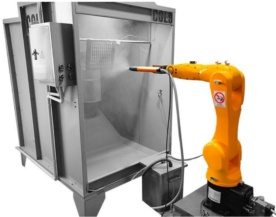
Рисунок 2.4. Приклад обладнання модуля нанесення покриття
