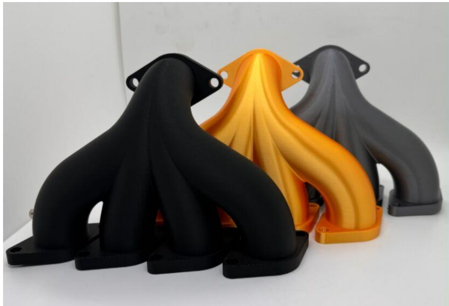
Рисунок 1.2. Друкований прототип маніфольда
