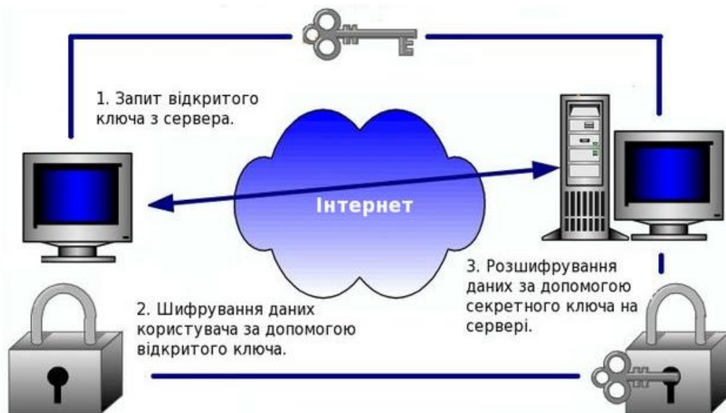
Рисунок 1.2 – Як працює шифрування за RSA
