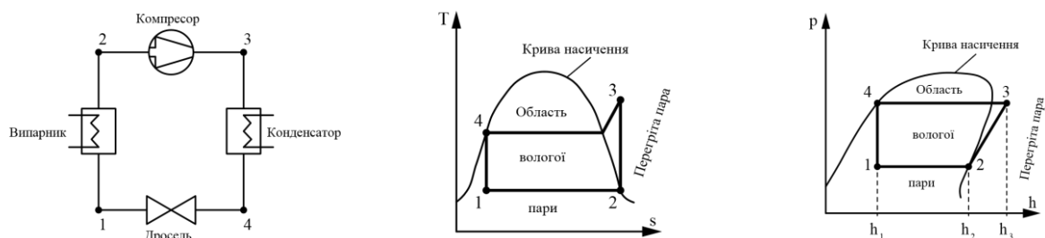
Рис.3 Ідеальний термодинамічний процес теплонасосної установки.
