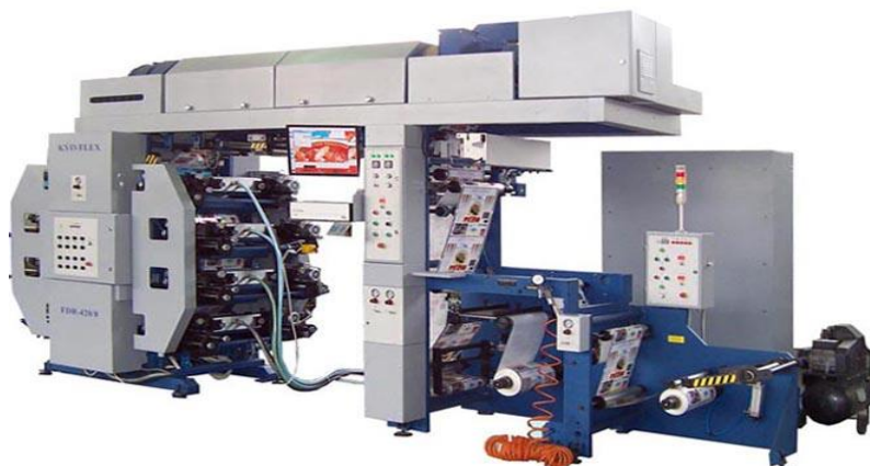
Рисунок 2.10 Флексографічна друкарська восьмифарбова машина з центральним друкарським циліндром ФДР-420/8 (Київполіграфмаш, Україна)
