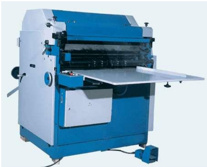
Рисунок 2.5 Однофарбова аркушева флексографічна друкарська машина ТПФ-850 (Україна)
