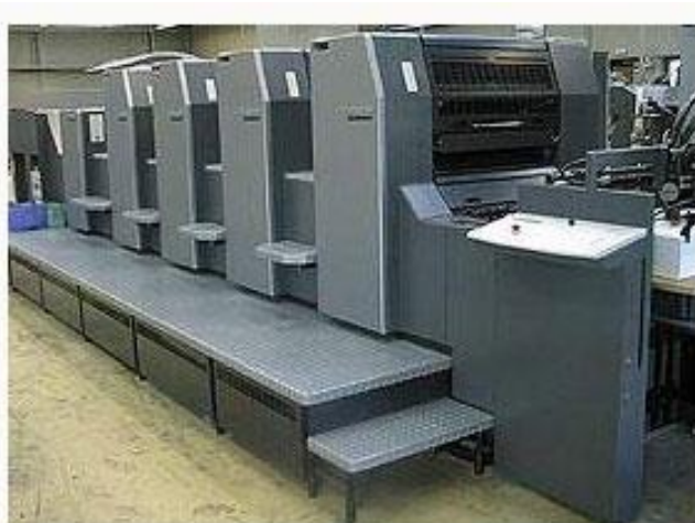
Рисунок 2.12 Гібридна ДМ SW4-4+L фірми Heidelberg
