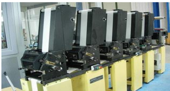
Рисунок 2.13 Гібридна ДМ COMCO CADET
