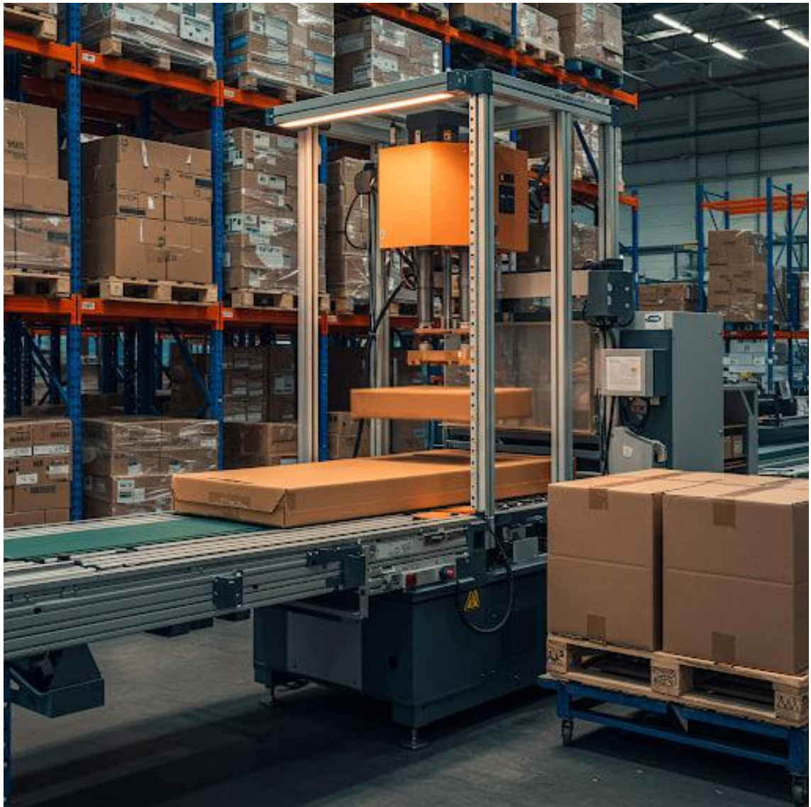
Рис. 1.8 Робота пневматичного захвату [23]
