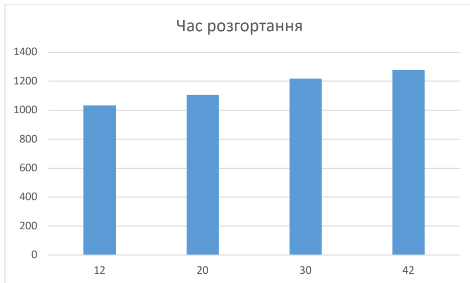
Рис. 4.17. Порівняльний графік часу розгортання платформи в умовах масштабування для топології Dragon-DeBruijn
