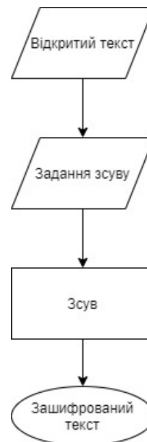
Рисунок 2.1 – Блок-схема алгоритму шифрування метода Цезаря
