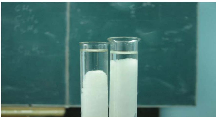
Рис.2. Фото танення гексадекану після 12 хвилин освітлення лампою
