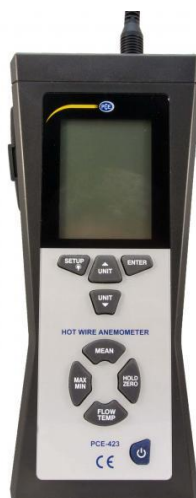
Рис. 1.7. Професійний теплової анемометр PCE-423
