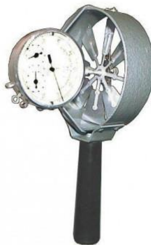
Рис. 1.4 Анемометр крильчатий АСО-3
