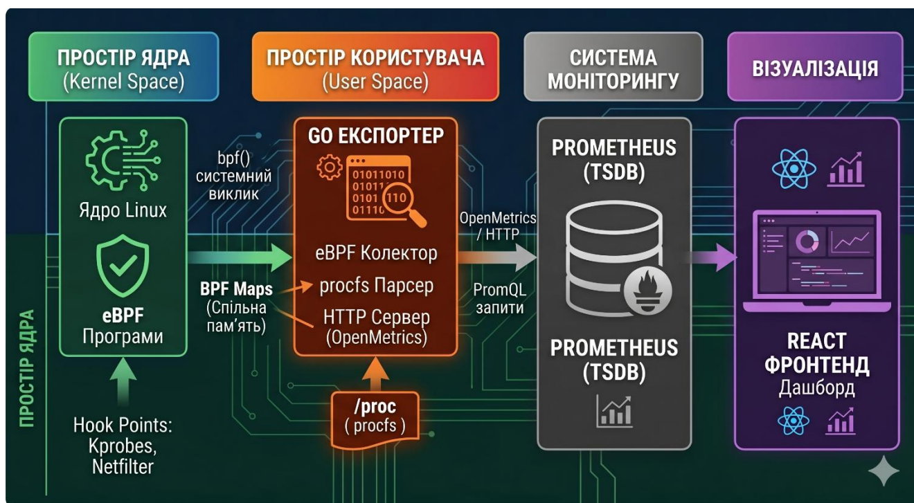
Рисунок 3.1 — Структурна схема архітектури комплексу моніторингу і напрямки потоків даних
