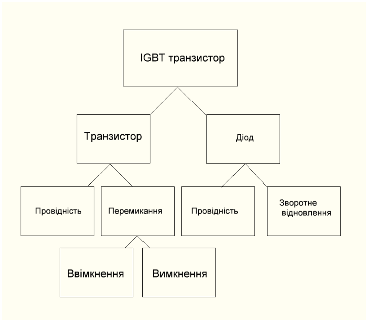
Рис.3.5 Перелік всіх втрат в IGBT транзисторі
