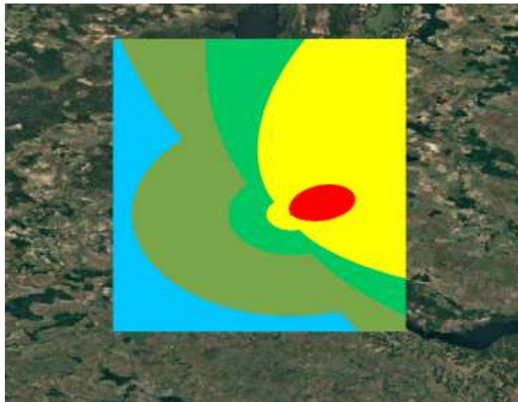
Рис.3.3 Зона покриття одnoseкторної антени (азимут 60^\circ ), розрахована за моделлю 3GPP
