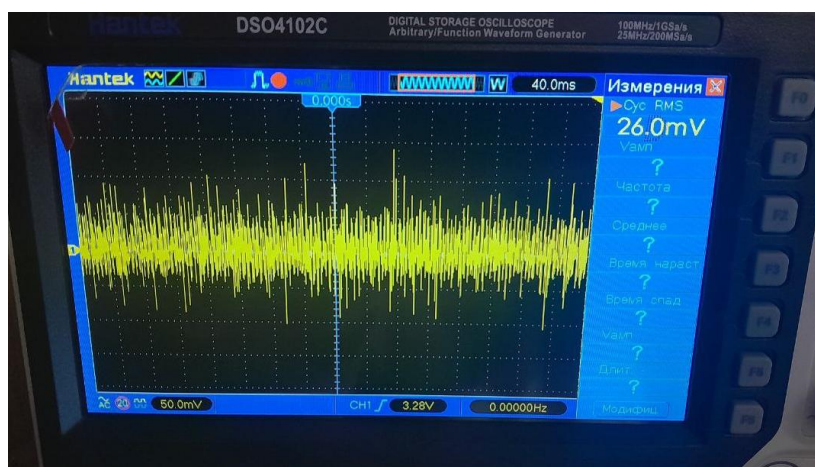
Рисунок 4.13 – Вихідні пульсації мережі 12 В при навантаженні 0.5 А
