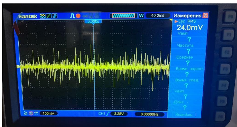
Рисунок 4.12 – Вихідні пульсації мережі 12 В при відсутності навантаження
