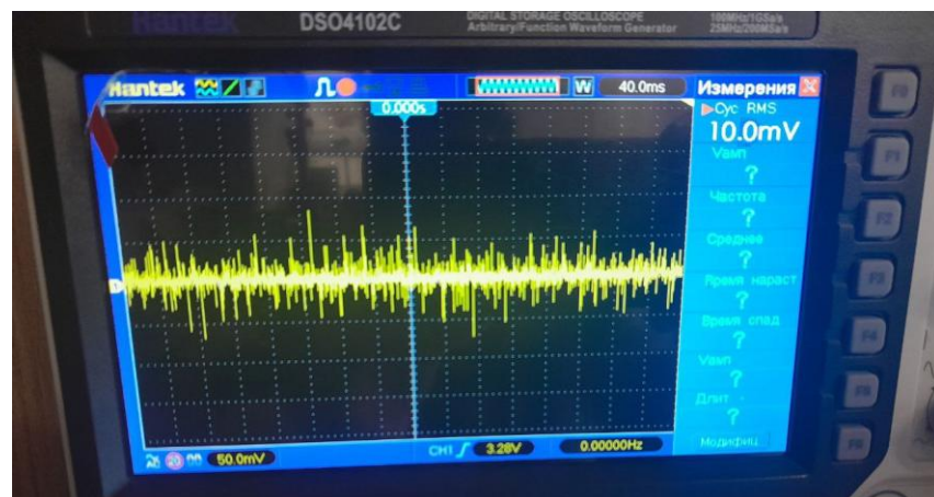
Рисунок 4.9 – Вихідні пульсації мережі 5.3 В при навантаженні 3 А
