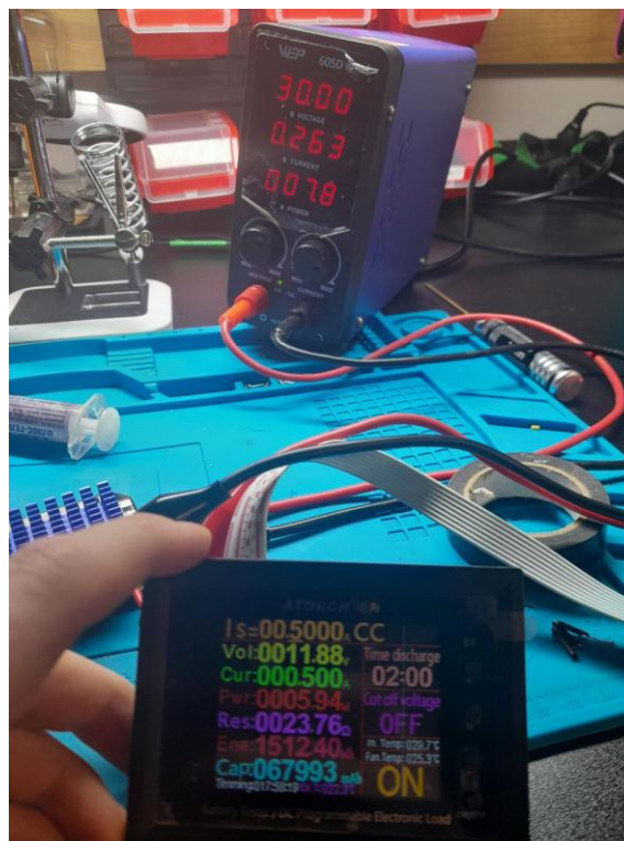
Рисунок 4.17 – Показники потужності мережі 12 В при легкому навантаженні
