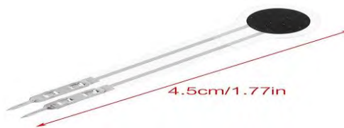
Рисунок 2.2.8 — Плівковий тензодатчик DF9-40
