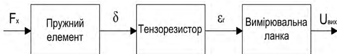
Рисунок 2.4 — Структурна схема тензодатчика
