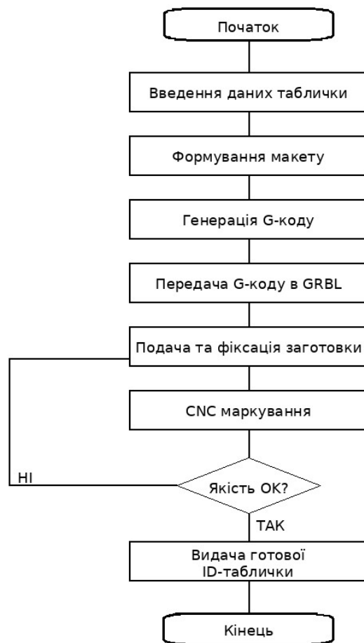
Рис. 2.2 Функціональна схема роботи автоматизованого комплексу
