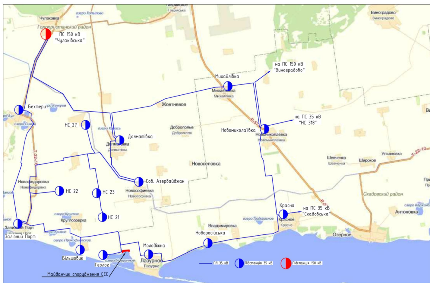
Рисунок 3.1 – Карта схема електричних мереж 35-150 кВ та місце розміщення СЕС
