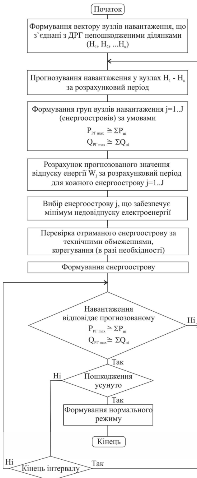
Рисунок 2.4 – Алгоритм управління комутаційними апаратами в СЕП з ДРГ
